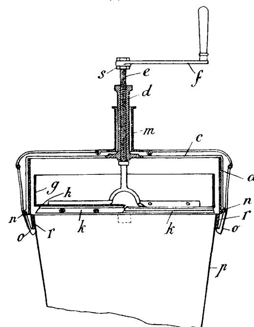
spindel (e) eine Trommel (g) gelagert ist, deren Boden mit radialen Spitzen und unter diesen mit Messern (k) versehen ist, so daß bei Drehung der Schraubenspindel die Trommel (g) gegen den Boden des Zuckerbrotes bewegt, und dieser durch das Messer (k) gerade geschnitten wird. —
